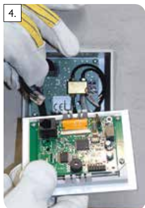
4. Prepojte vodiče pre zapojenie jednotky LUC.
